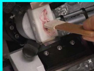
図2 Cryofilmの密着
