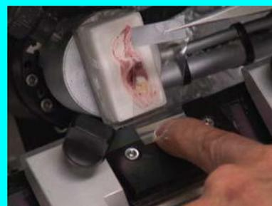
図1 Cryofilmの貼付
